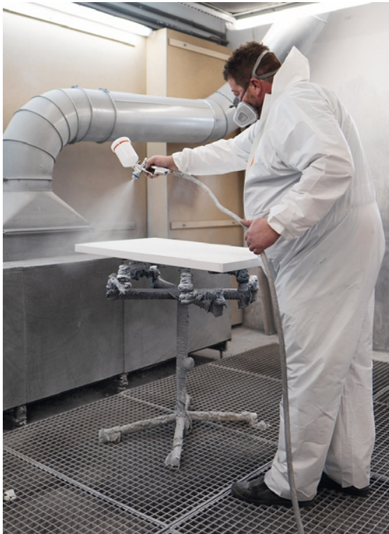
Obwohl der Wasserlack nicht nach Lösemittel riecht, sind Schutzmaßnahmen gegen das Einatmen des Lacknebels nötig
